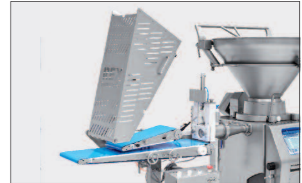
Formage de steaks hachés à l'aide de la guillotine et de la bande de formage
