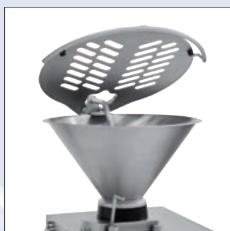
Trémie de 50 litres avec couvercle de protection
